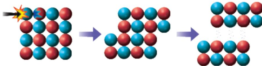
1. Golpe sobre el cristal.      2. Los iones se desplazan.      3. Los iones del mismo tipo se repelen.
