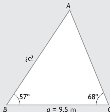
$$A = 180^\circ - (57^\circ + 68^\circ) = 55^\circ$$
