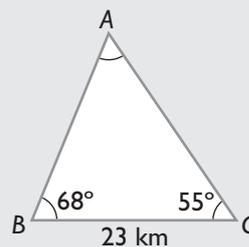
El ángulo  $A = 180^\circ - (68^\circ + 55^\circ) = 57^\circ$
