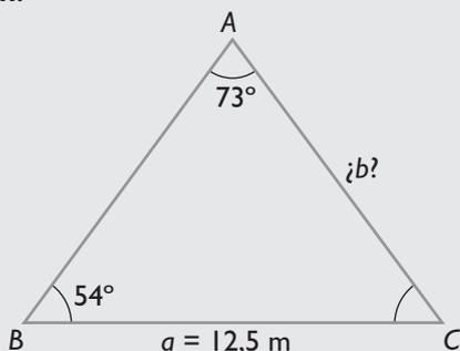
$$\frac{12,5}{\text{sen } 73^\circ} = \frac{b}{\text{sen } 54^\circ} \Rightarrow b = \frac{12,5 \cdot \text{sen } 54^\circ}{\text{sen } 73^\circ} = 10,57 \text{ m}$$
